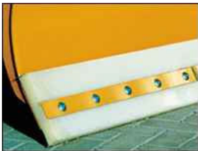
Typ SCH-V mit Vulkollanschürfleiste
