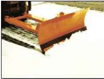
Typ SCH-G mit Gummischürfleiste
