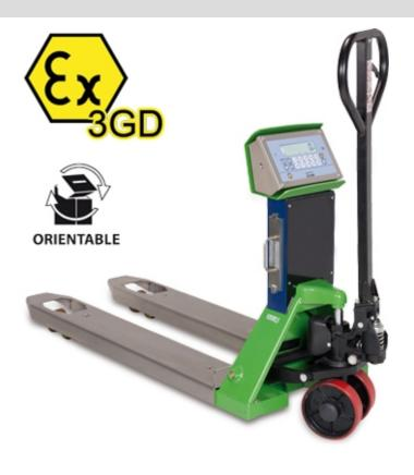
Gabelhubwagen mit Waagenfunktion, geeignet für raue Umgebungsbedingungen und Einsatz in explosionsgefährdeten Bereichen (ZONEN 2 und 22), Atex-Kennzeichnung Ex II 3GD IIC T6 T130°C X. Die Lastaufnahme über 4 Atex-zertifizierte Wägezellen garantiert optimale Wägeergebnisse in allen Betriebsarten. Die Vorteile sind hohe Genauigkeit und Zeitersparnis. Verfügbar auch in eichfähiger Version (CE-M).
