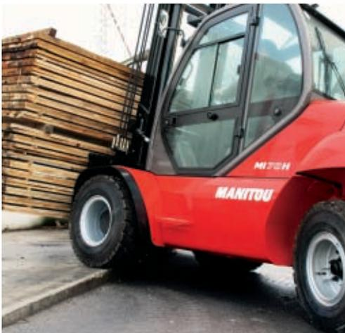
Dafür verfügt der MI über eine einmalige Bodenfreiheit von 260 mm.
