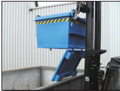
BKB bei Entleerung über Bodenklappe
